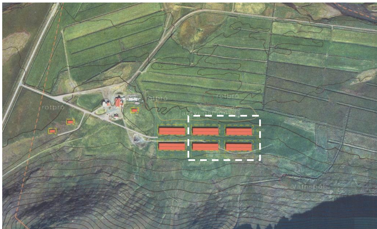
Mynd 2: Fyrirhugað framkvæmdarsvæði að Hurðarbaki, austan við núverandi eldishús (Arkitekt og Ráðgjöf ehf. 1999). Ný hús eru afmörkuð með hvítu brotalínu, en gul brotalínur sýna byggingareiti skv. deiliskipulagi
